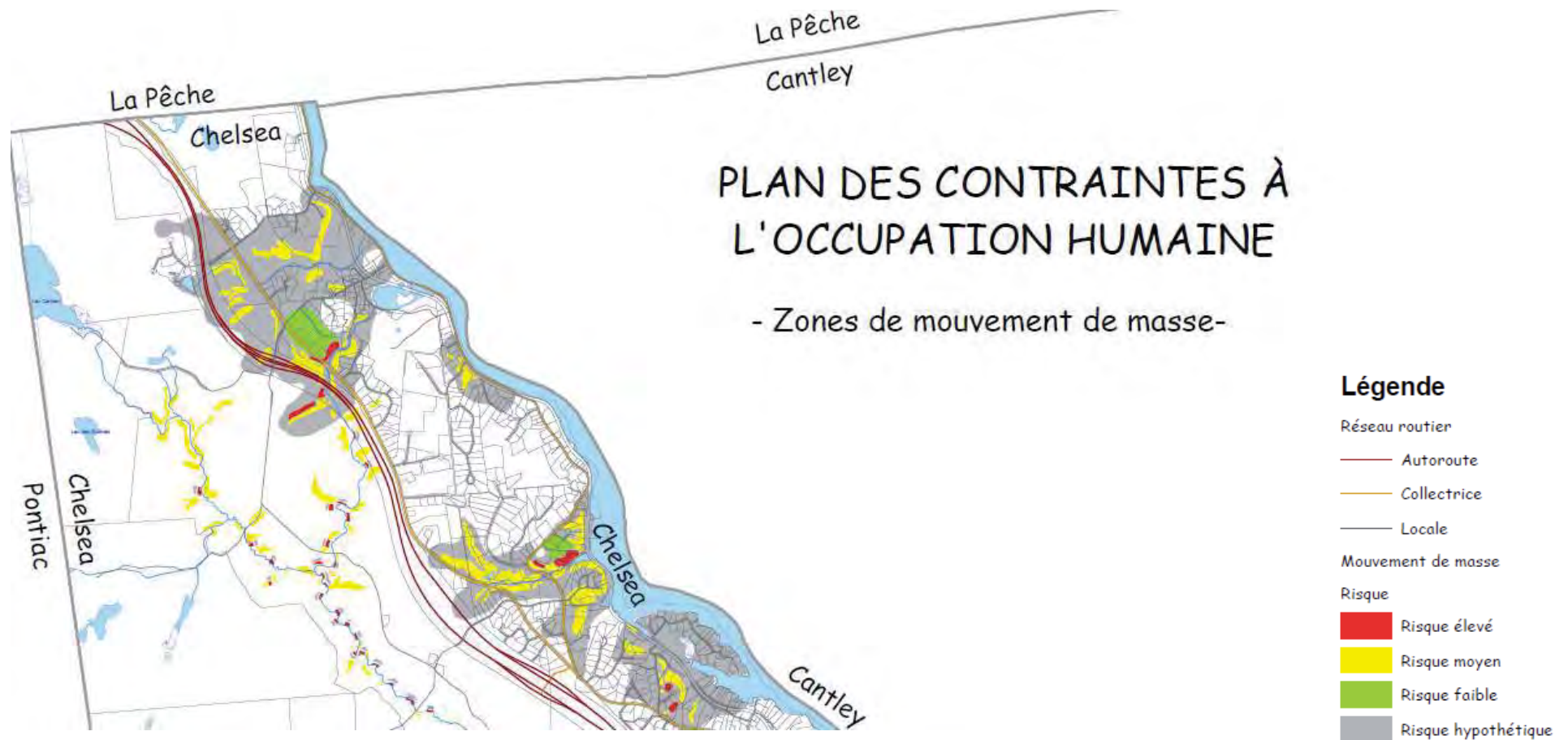
Figure 1 : Carte des zones mouvement de masse Zone des travaux de réfection du chemin de la Rivière Municipalité de Chelsea, Québec
