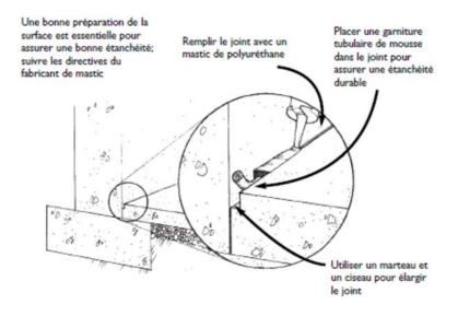
Les ouvertures pratiquées dans un plancher sur sol pour laisser passer des tuyaux ou d'autres objets doivent être rendues étanches au gaz qui se dégage du sol.
