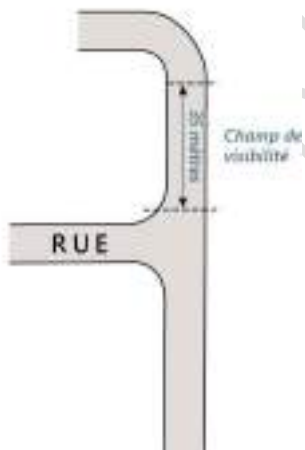
Figure 5 - intersection sur une rue de 15 mètres d'emprise
